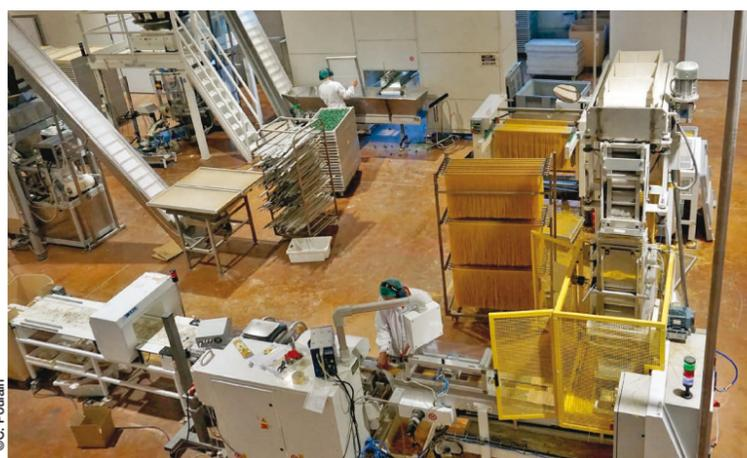
L'air chaud produit par la climatisation des locaux destinés aux salariés est recyclé pour le séchage des pâtes en atelier de production. Cela permet d'allier confort de l'environnement de travail et économies d'énergie.
